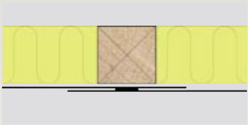
▲ (48) Samling af dampspærre udført med fugebånd
