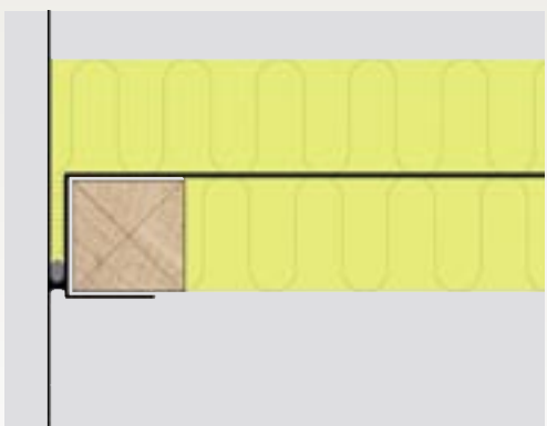
▲ (49) Tætning udføres med fugemasse ml. dampspærre og væg. Indvendig beklædning udeladt
