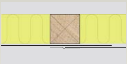
▲ (47) Samling af dampspærre udført med tape
