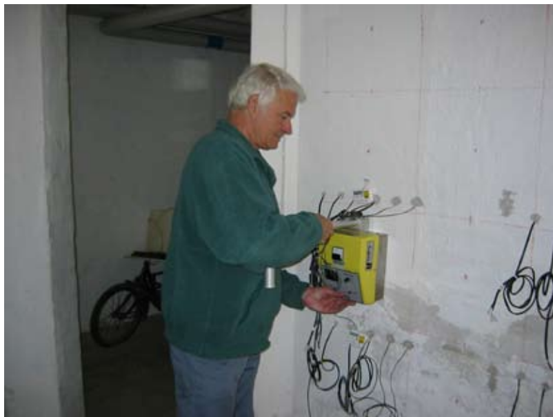
Fugtmåling med Troxler metoden (neutronkilde)
