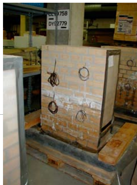
Laboratorieforsøg med kemisk fugtbremning
