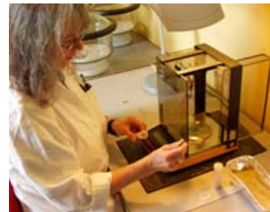
Tørre/veje metoden Øverst prøveudtagning Nederst vejning af fugtindhold før og efter udtørring.
